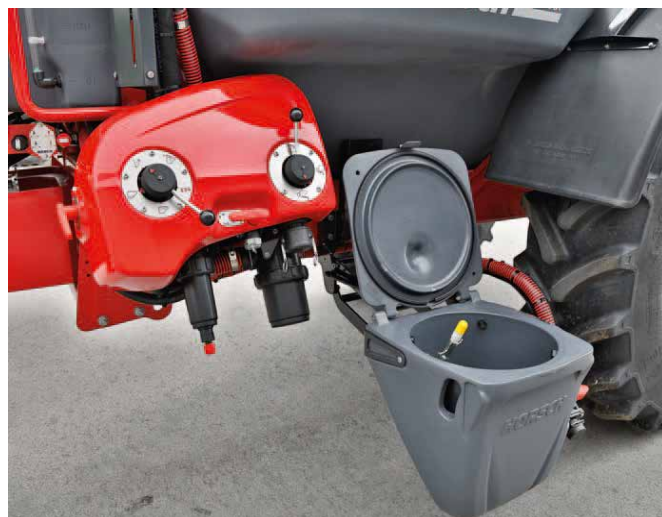
Заправна воронка з керуваними кранами
