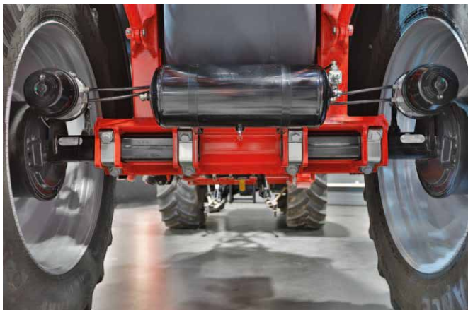
Регульована вісь із шириною колії в діапазоні 1,5–2,25 м
